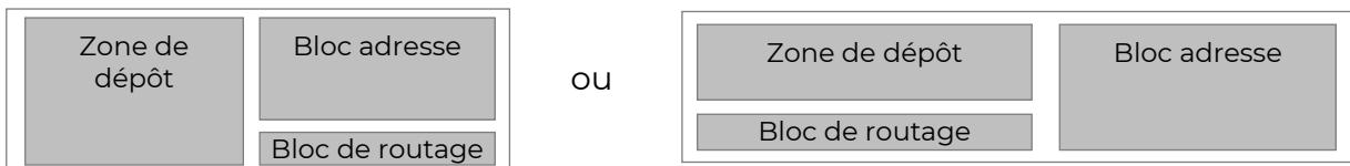
La zone de dépôt et les deux blocs, y compris entre eux, sont séparés d'au moins de 5 mm.
